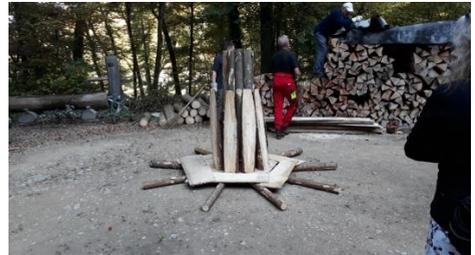
Der Meiler mit einem Durchmesser von 6 Metern und einer Höhe von rund 1.8 Metern wurde mit Tannästen abgedeckt, um die Zwischenräume zu schliessen und die „Löschli“ (das Abdeckmaterial aus Kohlenstaub und Erde) anzubringen. Der Meiler muss luftdicht abgedeckt werden.
