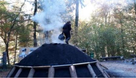
Neben dem Meiler wird ein Feuer entfacht. Die glühende Kohle des Feuers wird nun in den Schacht des Meilers geschüttet. Die Kohle im Schacht verliert an Grösse und die Köhlerin
